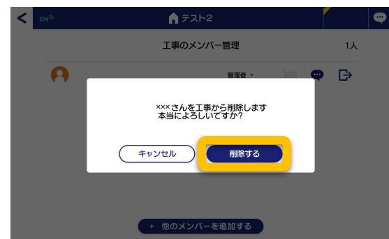
4 最後に残ったメンバー1人を退出させる際に、工事の削除に関して確認画面が出てきます。削除して問題ないかを再度確認し、問題なければ同意にチェックを入れ(①)、【削除する】をクリックします。(②)
